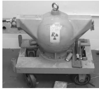
図10 \gamma 線非破壊検査装置
