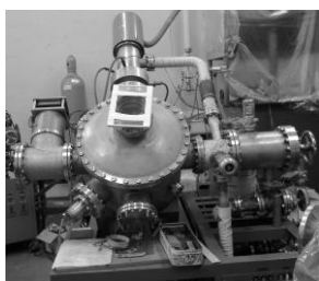
図7 低エネルギー電子線照射装置（100keV）
