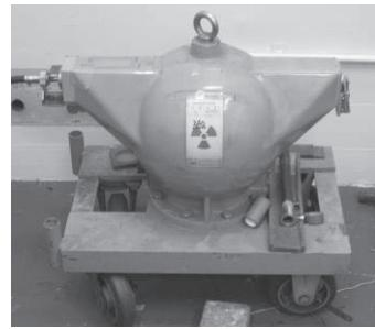
図 10  $\gamma$  線非破壊検査装置
