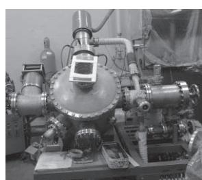
図 7 低エネルギー電子線照射装置（100keV）
