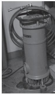
図 9 X 線非破壊検査装置
